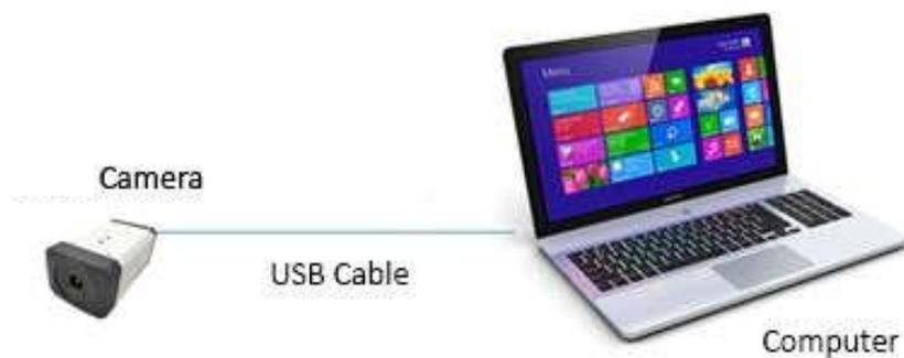
赤外線熱画像カメラとパソコンを接続するのに必要なUSBケーブルは1つだけです。接続モードとインターフェイスモデルを次の図に示します。
