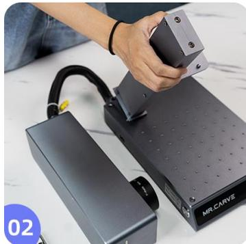
2. 2.昇降軸を立て、掘り込みに合わせ、差し込みます
