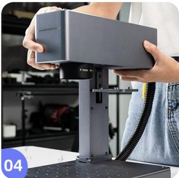
4. 昇降軸の直角プレートに光路装置を置き、後の4つのネジ穴と位置合わせます
