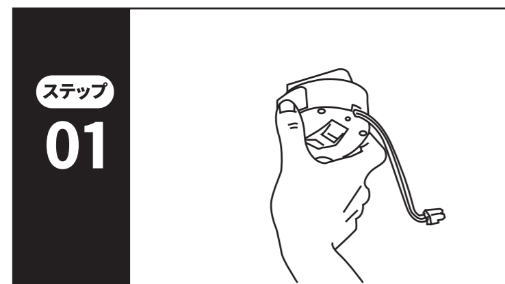
天井のソケットにアダプタを取り付ける
